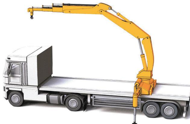
*Grue de chargement montée en position centrale*
