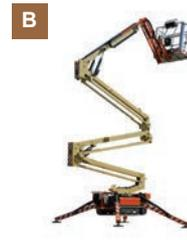
Le déplacement du châssis est permis avec la plate-forme en position haute, commandé depuis la plate-forme..
